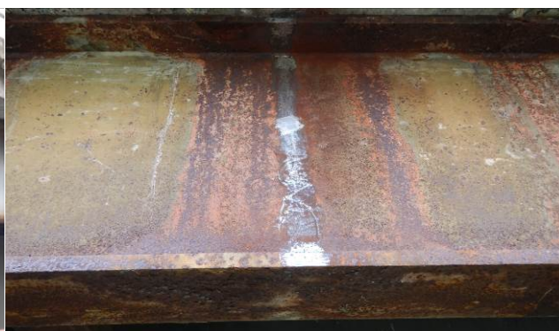
Obr. 4.13: Vybroušené místo na ocelovém nosníku připravené pro zkoušku ultrazvukem.
