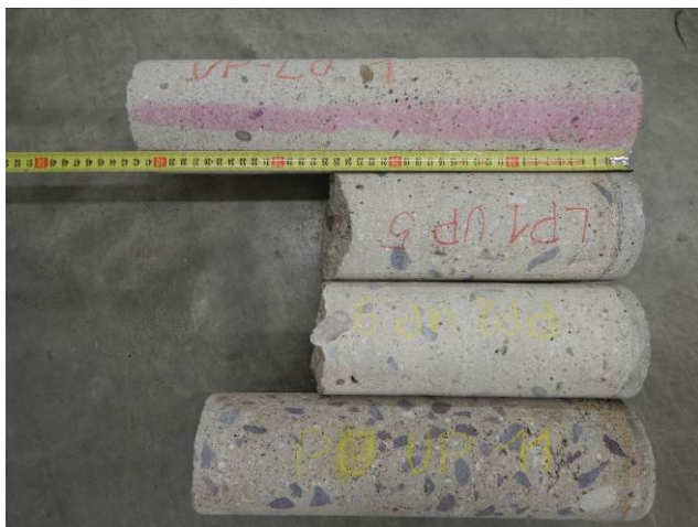
Obr. 4.4: Jádrové vývrty odebrané z dříků opěr a mezilehlých pilířů.
