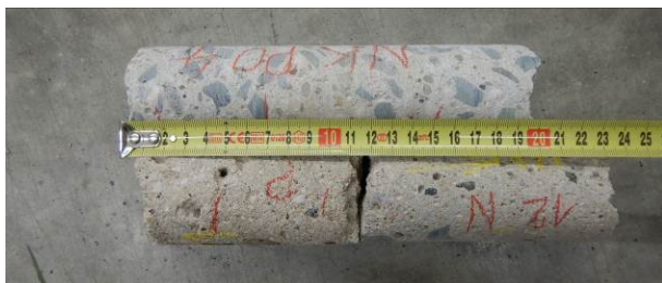
Obr. 4.6: Jádrové vývrty odebrané z NK.
