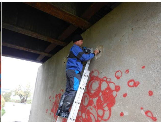
Obr. 4.8: Provádění odtrhových zkoušek na mezilehlých pilířích.
