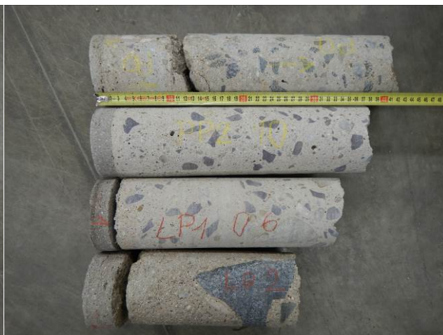
Obr. 4.5: Jádrové vývrty odebrané z úložných prahů opěr a mezilehlých pilířů.
