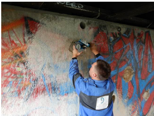
Obr. 4.7: Provádění odtrhových zkoušek na opěrách.
